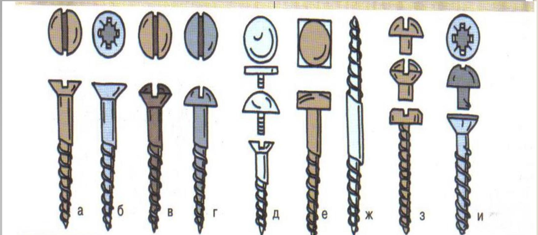
**а-** шурупы с плоской головкой; **б-** с крестообразной головкой; **в-** с полупотайной головкой; **г-** с полукруглой головкой; **д-** зеркальный шуруп; **е-** ключевой шуруп; **ж-** двойной шуруп; **з-** шуруп для работ по жести; **и-** шуруп по ДСП
